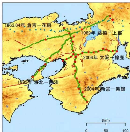
図 1 本研究で用いた人工地震を用いた地殻構造探査測線。緑の点、赤丸、赤い星印は、それぞれ観測点、バイプロサイズ多重発振点、発破点を表す。地図中の赤線は活断層を示す。
